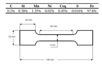
Figure 1. Specimen of longitudinal tensile test
