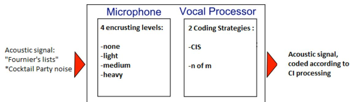
Fig. 1. Bloc diagram of the system : « Microphone + Cochlear Implant »
