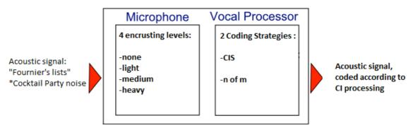
Fig. 1. Bloc diagram of the system : « Microphone + Cochlear Implant »
